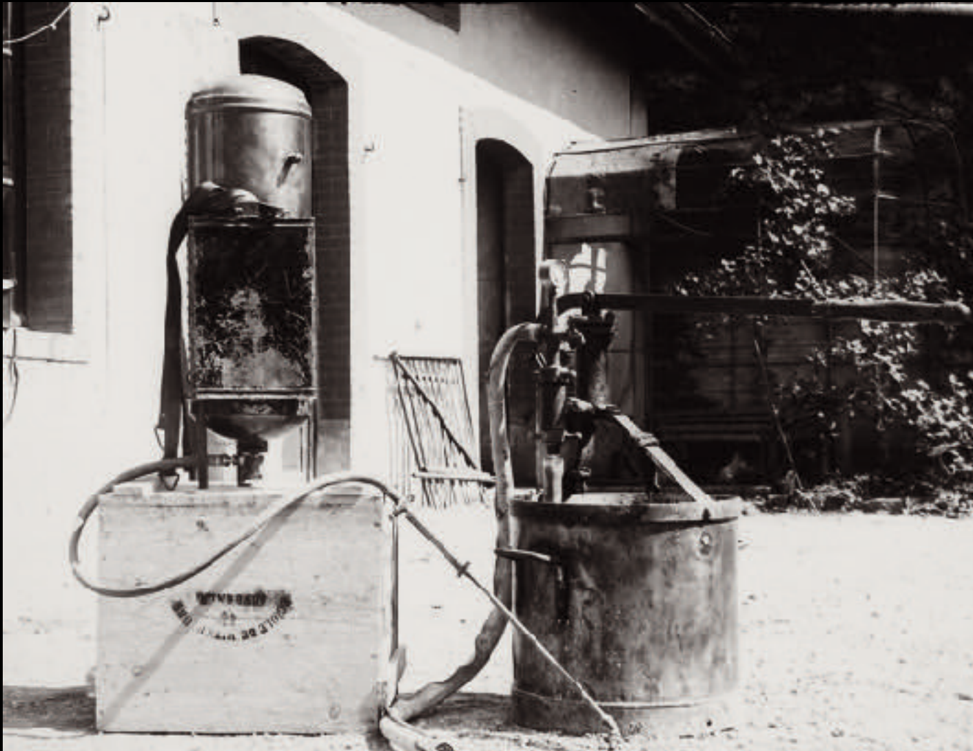
Pulvérisateur à pression avec pompe indépendante, système Berthoud et Dalicieux, « le Furet »
