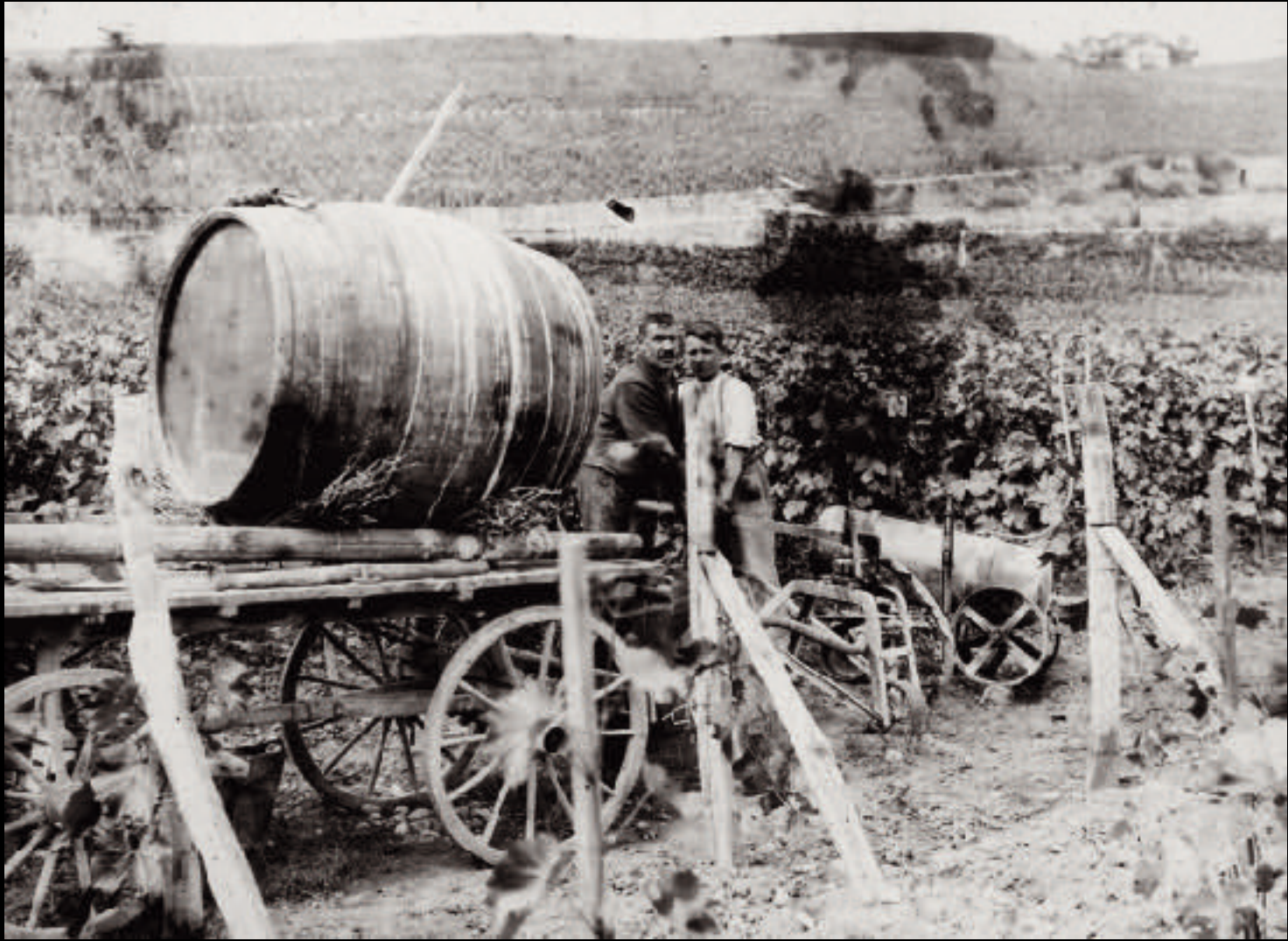
Machine à sulfater à traction animale, système Berthoud et Dalicieux, chargement du pulvérisateur
