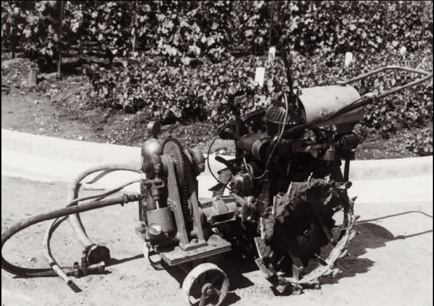
Compresseur Ruedin . Motoculteur transformé en compresseur avec pompe Piccolo
