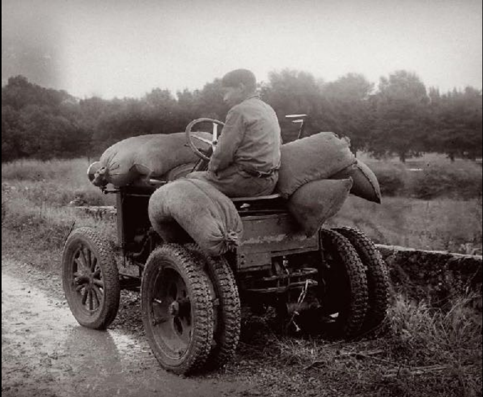
Tracteur Bühler utilisé pour le défonçage et chargé de sacs pour augmenter l'adhérence
