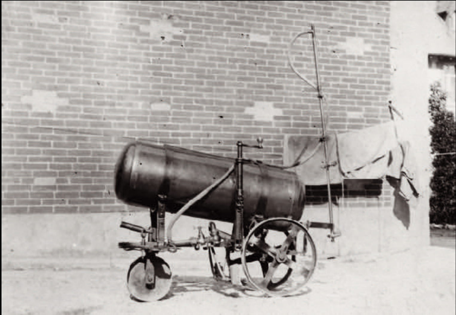
Machine à sulfater à traction animale, système Berthoud et Dalicieux
