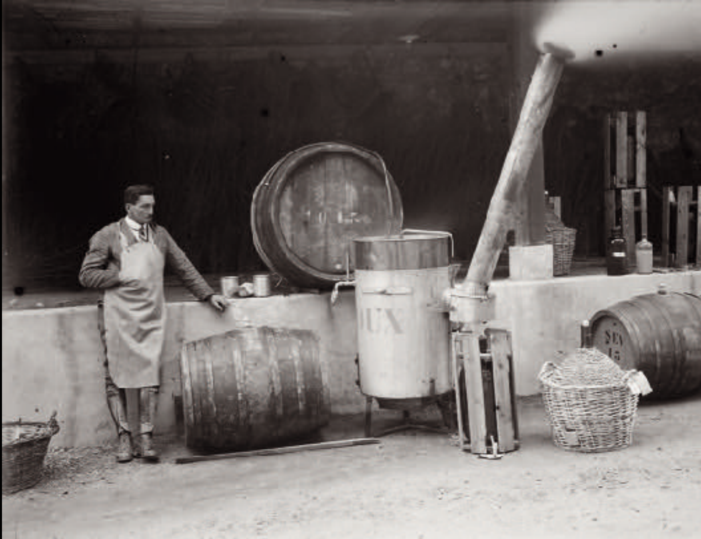
Stérilisation des moûts de raisin avec l'appareil Isliker
