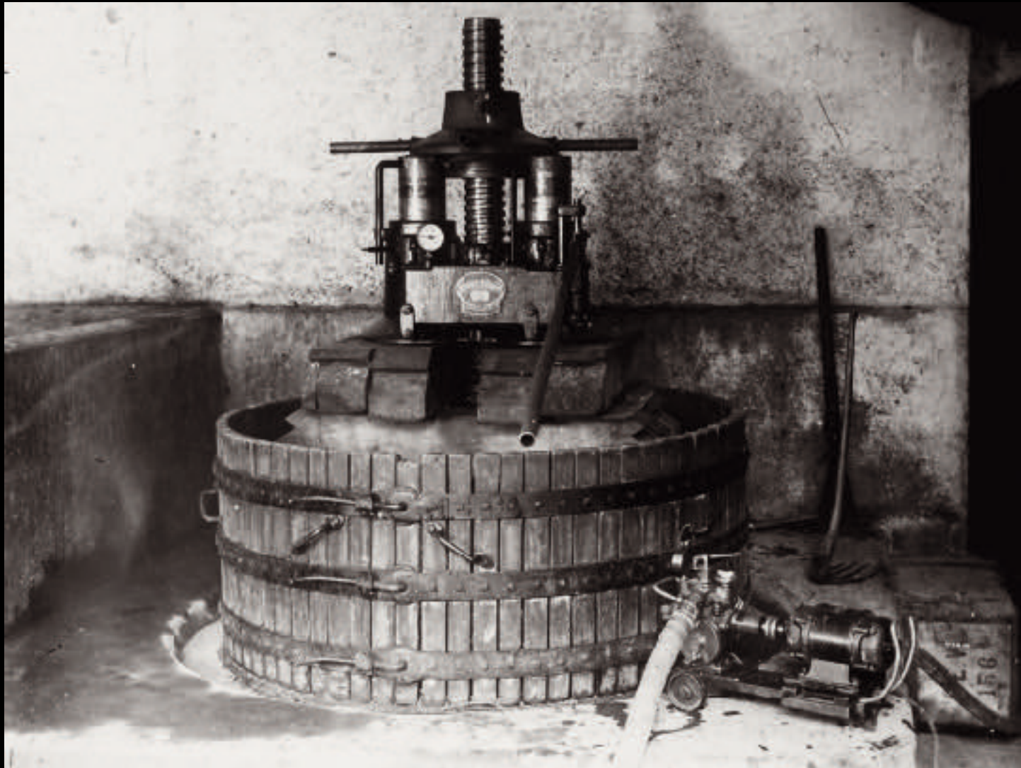
Application à un presseur ordinaire du corps hydraulique (glycérine) Hollmann ; pompe robinetterie de liège
